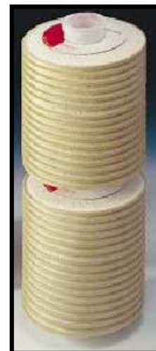
Elemento filtrante a doppia cartuccia, con eccezionali capacità di trattenimento delle particelle inquinanti, 2 micron assoluti con rapporto \beta \geq 1000
